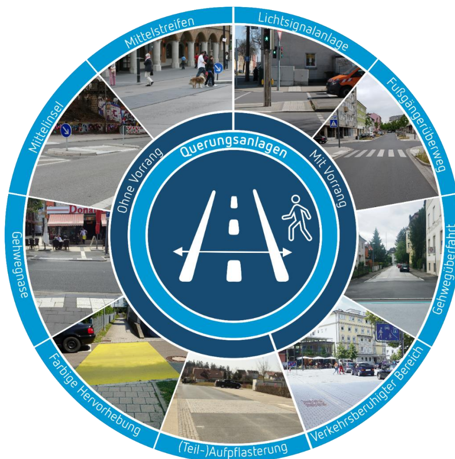
Abbildung 11: Unterschiedliche Querungsanlagen für Fußgänger
